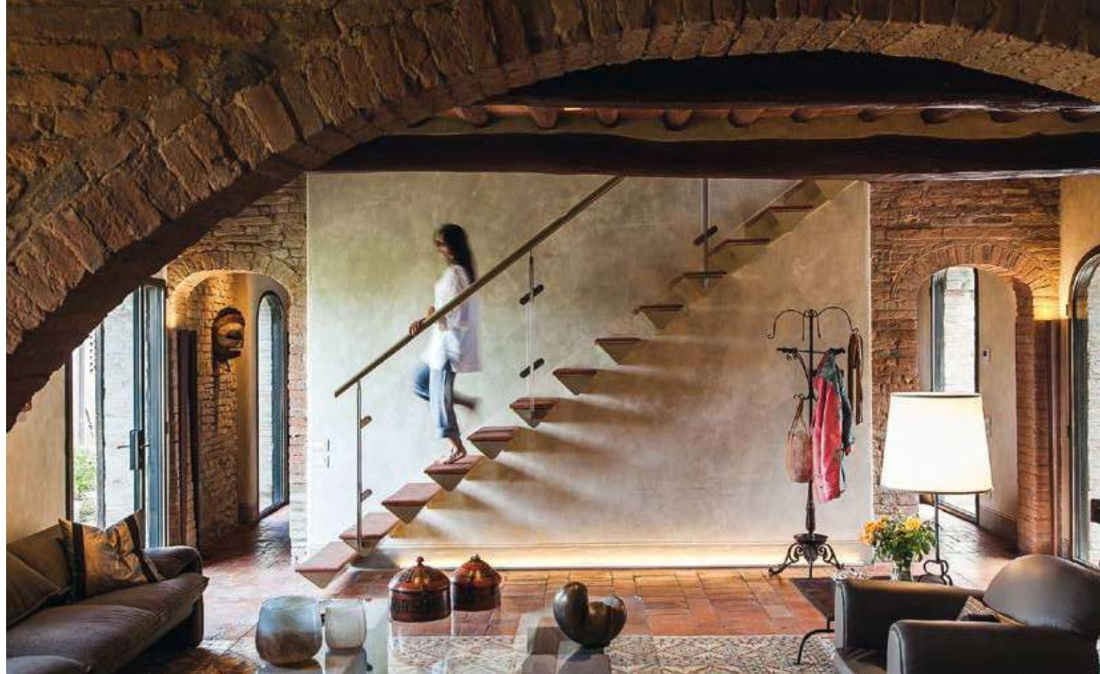
*La formidabile scala, realizzata interamente a sbalzo, può essere definita un progetto di alta ingegneria. Fulvio Di Rosa ci ha raccontato del fascio d'acciaio occultato dalla parete intonacata, dei tre ferri calandrati che sostengono ogni*
